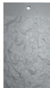
CSP-10 Ręczne śrutowanie a następnie obróbka strumieniowo-ścierna
