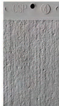
CSP-4: Delikatne/średnie śrutowanie/delikatne frezowanie/młotkowanie
